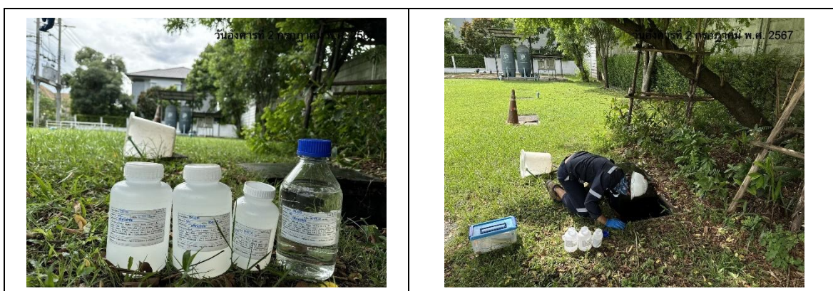
รูปที่ 3-1 ภาพถ่ายการเก็บตัวอย่างน้ำทิ้งหลังผ่านการบำบัด จากระบบบำบัดน้ำเสียรวมของโครงการบริเวณบ่อตรวจคุณภาพน้ำ
