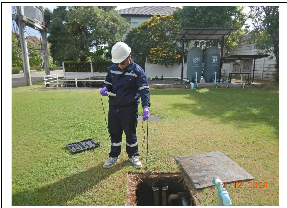
รูปที่ 3-3 ภาพถ่ายการเก็บตัวอย่างคุณภาพน้ำในบ่อเติมอากาศของระบบบำบัดน้ำเสียรวม เมื่อวันที่ 12 ธันวาคม 2567
